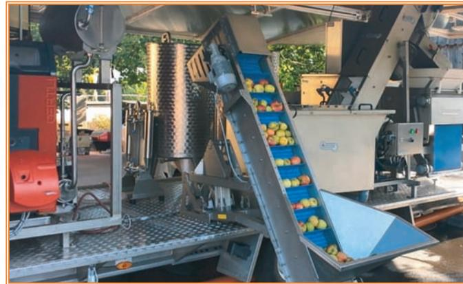
1. Das Obst wird durch ein Förderband in einen Waschbehälter befördert, wo durch einen Whirlpool-Effekt das Obst gründlich gereinigt wird. Anschließend wird das Obst über ein weiteres Transportband zur Rätzmühle befördert.
